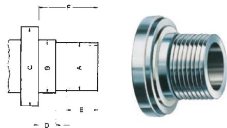
**Form A:** Gewinde und Durchgangslöcher im Flansch (ohne inneren Lochkreis).
